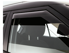
Calha de Chuva
